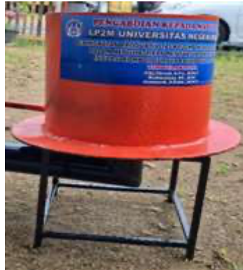
Gambar 3. Rangka kompor bunner
