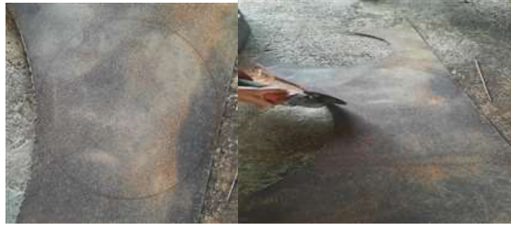
Gambar 5. Proses penandai dan Cutting alas kompor
