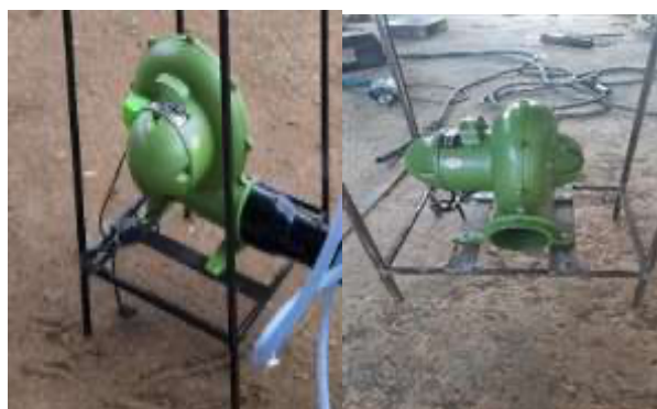
Gambar 2. Rangka kedudukan blower
