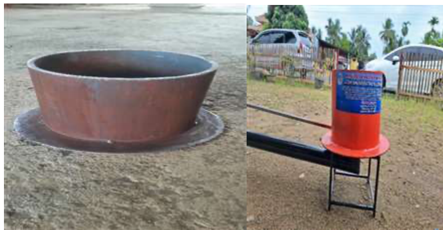
Gambar 9. Proses pembuatan tunggu kompor bunner
