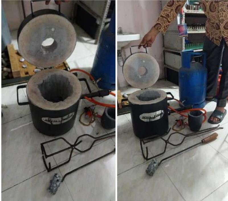
Gambar 1. Tungku pengecoran *Crusible*
