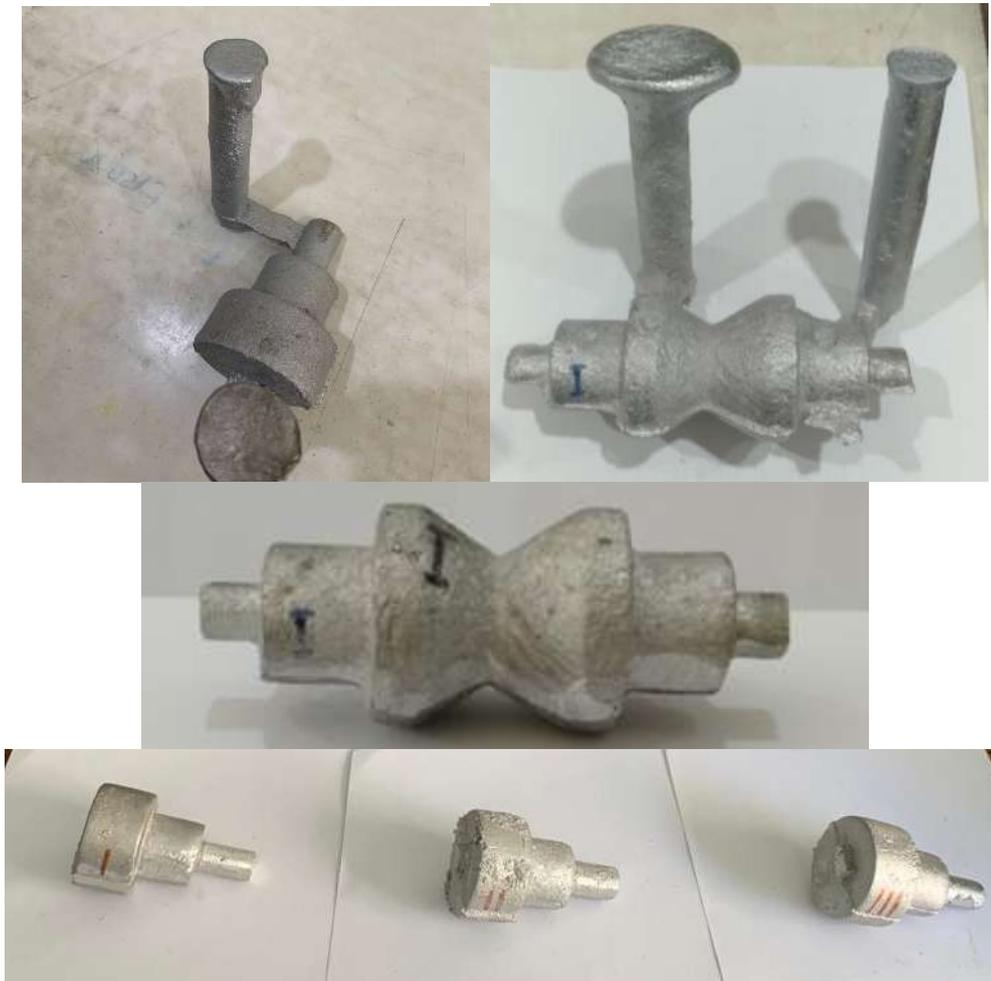
Gambar 7. Hasil Pengecoran Menggunakan Pola Dari Kayu
