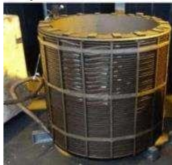
Gambar 7. Transformator HT Rakitan [2]
