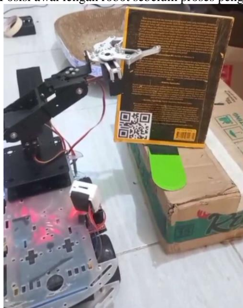
Gambar 8. Proses penjepitan buku oleh lengan robot
