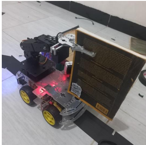
Gambar 9. Proses pengangkatan dan pemindahan buku oleh robot
