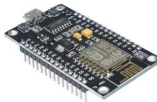
Gambar 3. NodeMCU ESP8266
